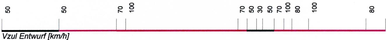
Das Streckenband zeigt, dass in den anbaufreien Abschnitten immer wieder Geschwindigkeitsreduzierungen auf 80 bzw. 70 km/h erforderlich werden. Des Weiteren ist im angebauten Abschnitt eine Beschränkung auf 30 km/h erforderlich.
